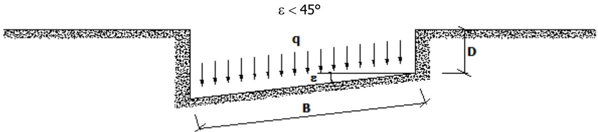
**Calcolo dei fattori di riduzione per rottura a punzonamento  $\psi_c, \psi_q, \psi_\gamma$**
