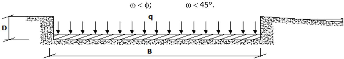
**Calcolo dei fattori di inclinazione del piano di posa  $g_c, g_q, g_\gamma$**
