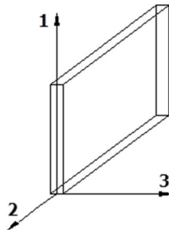
Si rende necessario, a questo punto, meglio precisare le modalità con cui EdiLus restituisce i risultati di calcolo. Nel modello di calcolo agli elementi finiti ciascun setto è discretizzato in una serie di elementi tipo "shell" interconnessi; il solutore agli elementi finiti integrato nel programma EdiLus, definisce un riferimento locale per ciascun elemento shell e restituisce i valori delle tensioni esclusivamente rispetto a tali riferimenti.
